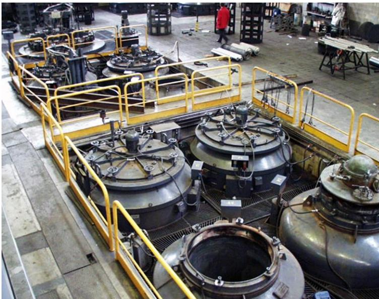
*Figura 1: Forni a pozzo per nitrurazione gassosa (T.T.N. - Trattamenti Termici Nervianesi, Nerviano - MI)*
