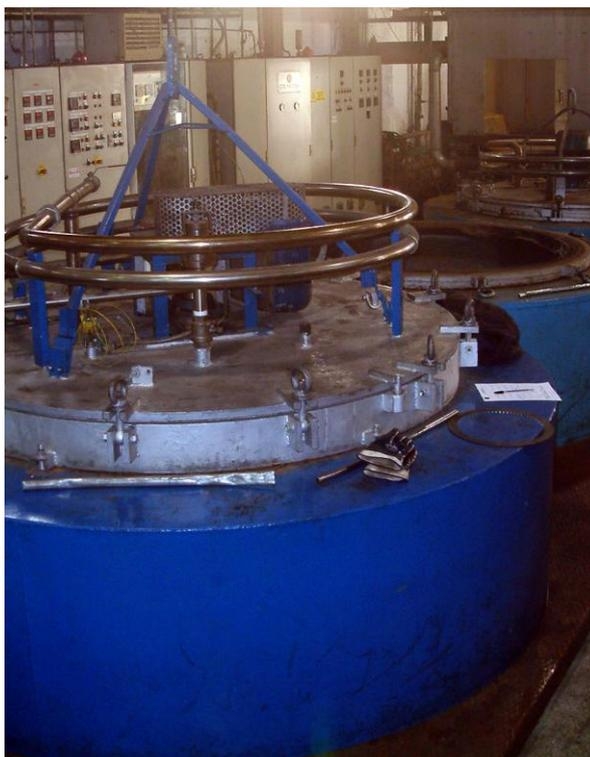
*Figura 2: Forni a pozzo per nitrurazione gassosa (Colmegna S.p.A. Siziano - PV)*
