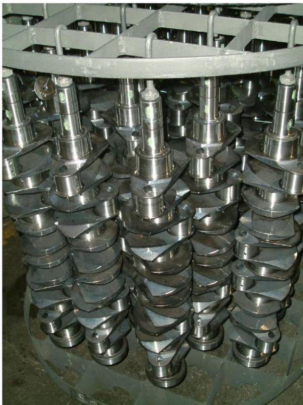
*Figura 1: Esempio tipico di pezzi meccanici (alberi a gomiti) sottoposti al trattamento di bonifica.*
