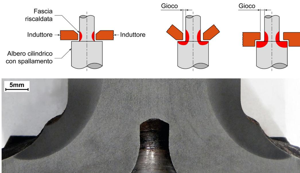
**Figura 14.9** – Soluzioni tecnologiche con induttori opportunamente sagomati per temperare forme irregolari [tratto da Rudnev et al 2003]; esempio di uno spallamento indurito superficialmente in un albero di trasmissione [Laboratori Omeco S.r.l., Monza – MB].
