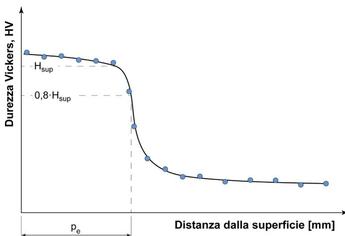
**Figura 14.2** – Schema per la determinazione della profondità efficace,  $p_e$ , di uno strato temprato superficialmente ( $H_{sup}$  durezza minima richiesta).
