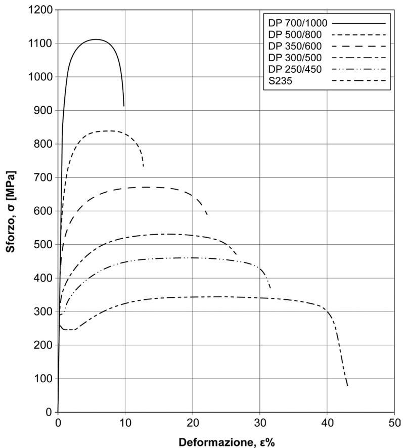
**Figura 11.3** – Curve sforzo-deformazione per alcuni acciai DP (qui identificati con la sigla DP seguita dai valori minimi di  $R_s$  ed  $R_m$ ) a confronto con un generico acciaio EN S235 [tratto da Keeler et al. 2017].
