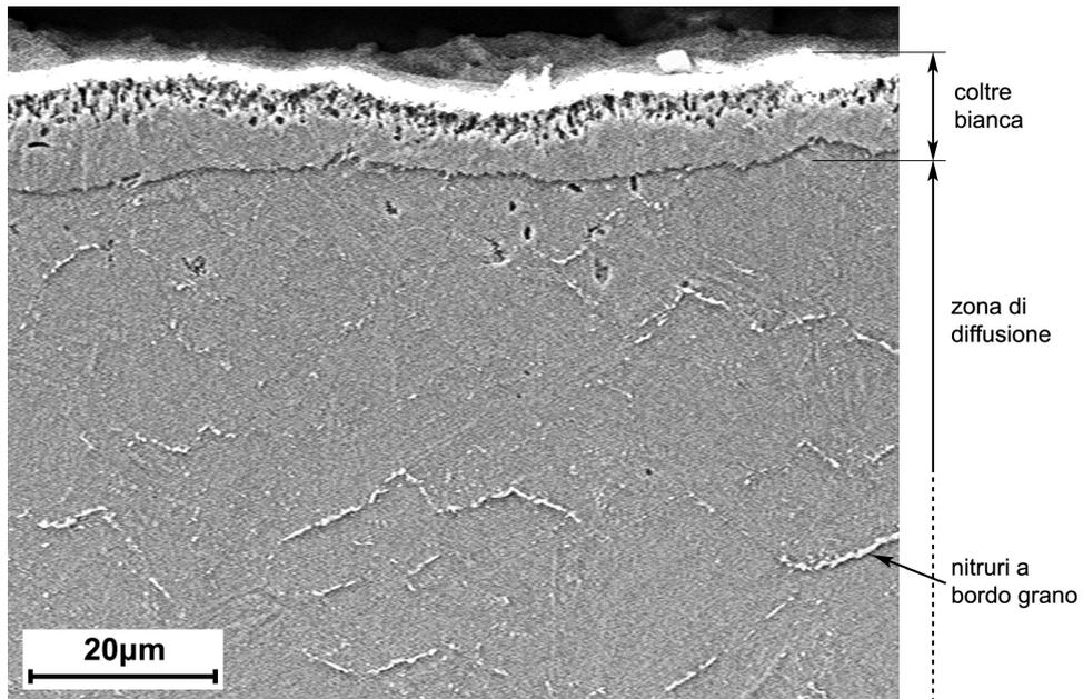
**Figura 18.6** – Aspetto tipico di uno strato nitrurato su acciaio EN 42CrMo4 ottenuto dopo nitrurazione gassosa (30 ore di trattamento a 530°C). Microscopio elettronico a scansione; attacco: Nital 2% [Laboratori del Dipartimento di Meccanica del Politecnico di Milano – MI].
