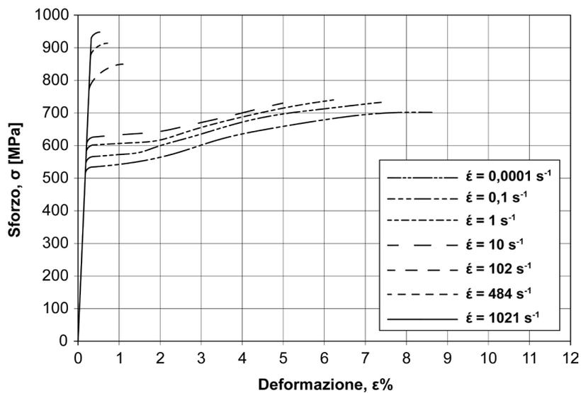
**Figura 5.8** – Andamento della curva sforzi-deformazioni di un acciaio EN 20MnMoNi-5 allo stato bonificato all'aumentare della velocità di deformazione a temperatura ambiente [tratto da Davis et al. 1982].
