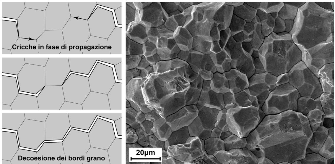
**Figura 5.15** – Illustrazione schematica del meccanismo di decoesione dei bordi grano ed aspetto al microscopio elettronico a scansione di una superficie di frattura intergranulare [Laboratori del Dipartimento di Meccanica del Politecnico di Milano – MI].
