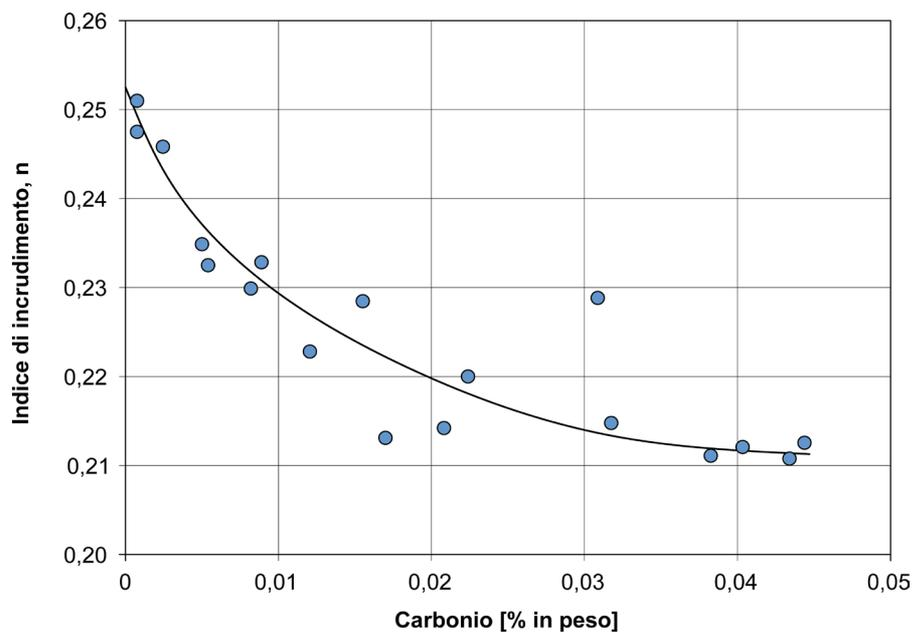
**Figura 9.7** – Andamento dell'indice di incrudimento  $n$  dell'equazione di Hollomon in relazione al tenore di carbonio dell'acciaio (acciai a bassissimo tenore di carbonio, calmati all'alluminio e ricotti in linea a 700°C e 850°C) [tratto da Ono et al. 1982].
