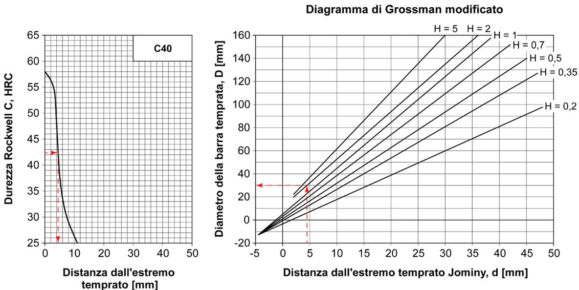
**Figura 13.5** – Curva Jominy per l'acciaio EN C40 e diagramma di Grossmann modificato. Esempio di calcolo del diametro di barre col 50% di martensite a cuore temprate usando un fluido di drasticità  $H = 2$ .
