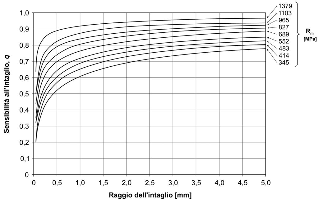
**Figura 6.26** – Andamento della sensibilità all'intaglio  $q$  al variare del raggio dell'intaglio e del carico unitario di rottura dell'acciaio per sollecitazioni flessionali ed assiali di fatica. Nel caso di sollecitazioni torsionali di fatica si deve considerare una curva avente un carico unitario di rottura maggiore di 138MPa rispetto all'acciaio effettivamente usato [tratto da Norton 1997].
