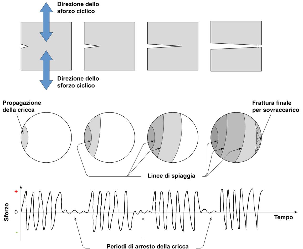
**Figura 6.6** – Illustrazione schematica di una frattura per fatica con formazione di linee di spiaggia in un componente reale soggetto a una sollecitazione ciclica casuale [tratto da Brooks C. R., Choudhuri A., Metallurgical Failure Analysis, McGraw-Hill, New York, 1993].
