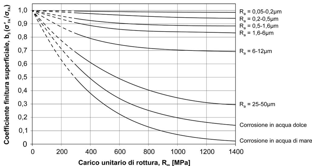
**Figura 6.24** – Andamento del coefficiente di finitura superficiale  $b_3$  che consente di definire il limite di fatica del componente ( $\sigma'_{FA}$ ) a partire dal limite di fatica del materiale ( $\sigma_{FA}$ ) in funzione della rugosità del pezzo. Il dato d'ingresso in ascissa è il carico unitario di rottura dell'acciaio [tratto da Brand et al 1991].
