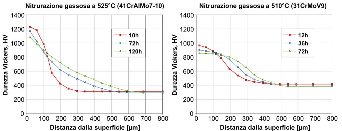
**Figura 18.9** – Andamento del profilo di durezza dopo nitrurazione gassosa: (a sinistra) su acciaio EN 41CrAlMo7-10 trattato a 525°C, (a destra) su acciaio EN 31CrMoV9 trattato a 510°C [Laboratori del Dipartimento di Meccanica del Politecnico di Milano – MI].
