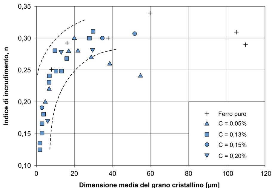
**Figura 9.8** – Andamento dell'indice di incrudimento  $n$  dell'equazione di Hollomon in relazione alla dimensione media del grano cristallino per il ferro puro e per acciai a basso tenore di carbonio [tratto da Morrison 1966].
