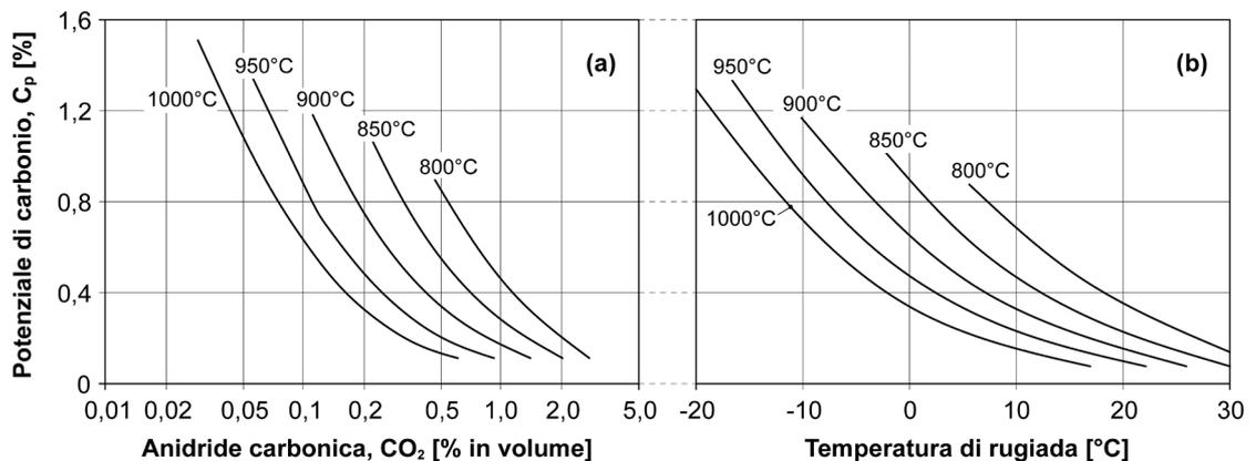
**Figura 17.8** – Esempi di diagrammi che permettono di determinare il potenziale di carbonio  $C_p$ , in atmosfere arricchite di metano con *endogas* come gas portante, in funzione della temperatura di processo e (a) del tenore di  $CO_2$  o (b) del punto di rugiada [tratto da Davis 2002].
