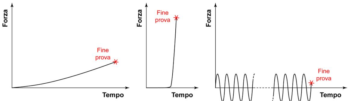
**Figura 1.1** – Schematizzazione dell'andamento della forza applicata nel tempo fino alla rottura del provino per ogni tipologia di prova.
