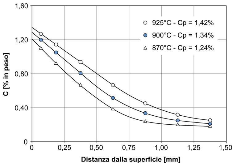
**Figura 17.4** – Effetto della temperatura di trattamento e del potenziale di carbonio (pari alla saturazione dell'austenite alle varie temperature) su processi di cementazione della durata di 4 ore per un acciaio tipo EN C20 [tratto da Davis 2002].
