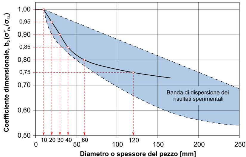
**Figura 6.22** – Andamento del coefficiente dimensionale  $b_2$  che permette di definire il limite di fatica del componente ( $\sigma'_{\text{FA}}$ ) a partire dal limite di fatica del materiale ( $\sigma_{\text{FA}}$ ) in funzione della dimensione del pezzo [tratto da Davoli et al 2003].
