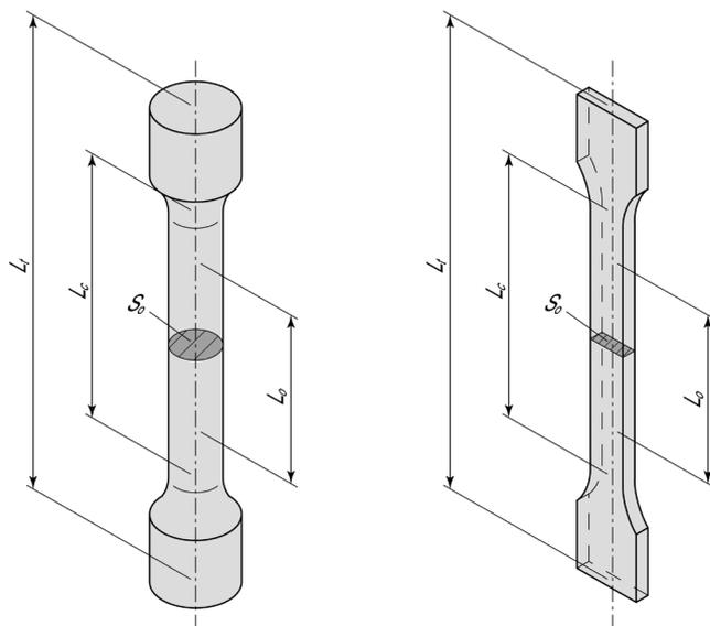
**Figura 2.3** – Geometria tipica dei provini di trazione: (a sinistra) il provino cilindrico, (a destra) il provino prismatico. Nota:  $L_t$ : lunghezza totale,  $L_c$ : lunghezza del tratto calibrato a sezione costante,  $L_0$ : lunghezza del tratto utile,  $S_0$ : sezione nel tratto utile.
