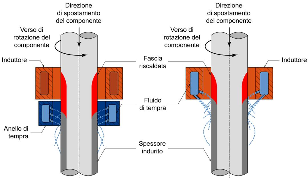
**Figura 14.12** – Schema del processo di tempra a induzione progressiva: (a sinistra) sistema con induttore e raffreddamento separati, (a destra) sistema con induttore e raffreddamento combinati. Le frecce in linea spessa indicano le direzioni di traslazione e di rotazione della barra [tratto da Rudnev et al 2003].
