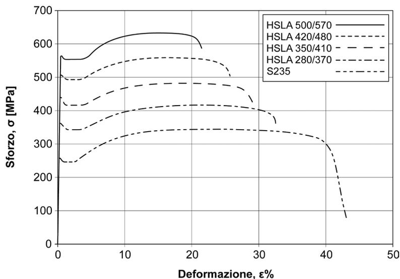
**Figura 10.7** – Curve sforzo-deformazione per alcuni acciai microlegati (qui identificati con la sigla *HSLA* seguita dai valori minimi di  $R_s$  ed  $R_m$ ) a confronto con un generico acciaio EN S235 [tratto da Keeler et al. 2017].
