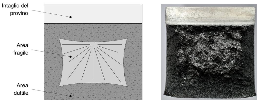
**Figura 4.5** – Schematizzazione ed esempio reale della superficie di frattura di un provino di resilienza con l’indicazione delle aree di cedimento duttile e fragile (acciaio automatico tipo EN 11SMnPb37, temperatura di prova: 20°C, KV = 21J; percentuale di frattura fragile: 35%). [Laboratori Hammer S.r.l., Rho – MI].
