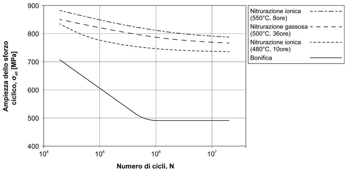
**Figura 6.19** – Curve di Wöhler in flessione rotante ( $R = -1$ ) per un acciaio EN 42CrMo4 ( $R_s = 780\text{MPa}$ ;  $R_m = 980\text{MPa}$ ), allo stato bonificato e allo stato bonificato seguito da nitrurazione con differenti modalità [tratto da ASM-H.1 1991].
