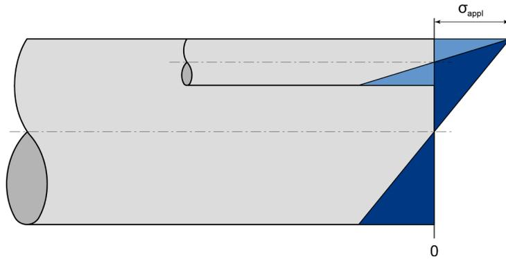
**Figura 6.21** – Andamento degli sforzi lungo la sezione per due componenti di differente diametro, soggetti a flessione, a parità di sforzo applicato in superficie ( $\sigma_{\text{appl}}$ ). Nel pezzo di piccola dimensione il gradiente degli sforzi è molto maggiore (azzurro) rispetto al pezzo più grande (blu).
