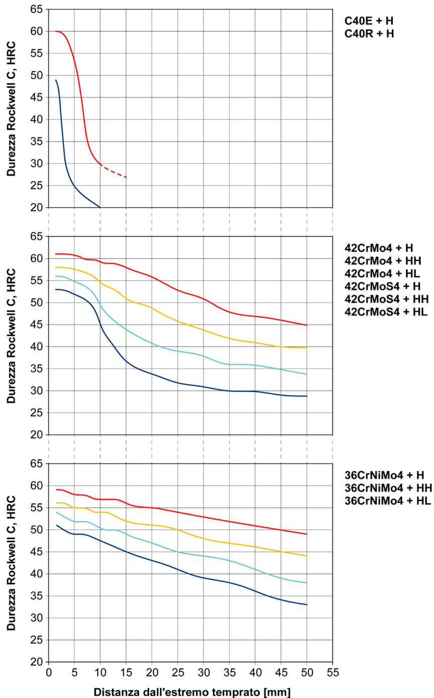
**Figura 13.3** – Bande di temprabilità Jominy per gli acciai EN C40, EN 42CrMo4 ed EN 36CrNiMo4. Curva limite superiore (linea rossa); curva limite superiore per acciai a bassa temprabilità (linea arancione); curva limite inferiore per acciai ad elevata temprabilità (linea azzurra); curva limite inferiore (linea blu) [tratto da EN ISO 683-1 ed EN ISO 683-2].
