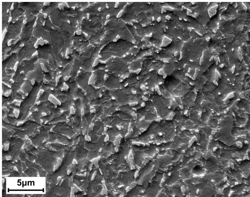
**Figura 11.4** – Aspetto metallografico a bassi e ad alti ingrandimenti di un acciaio DP tipo EN HCT980X. Si notino le isole di martensite circondate dalla finissima microstruttura ferritica; attacco: Nital 2% [Laboratori del Dipartimento di Meccanica del Politecnico di Milano – MI].
