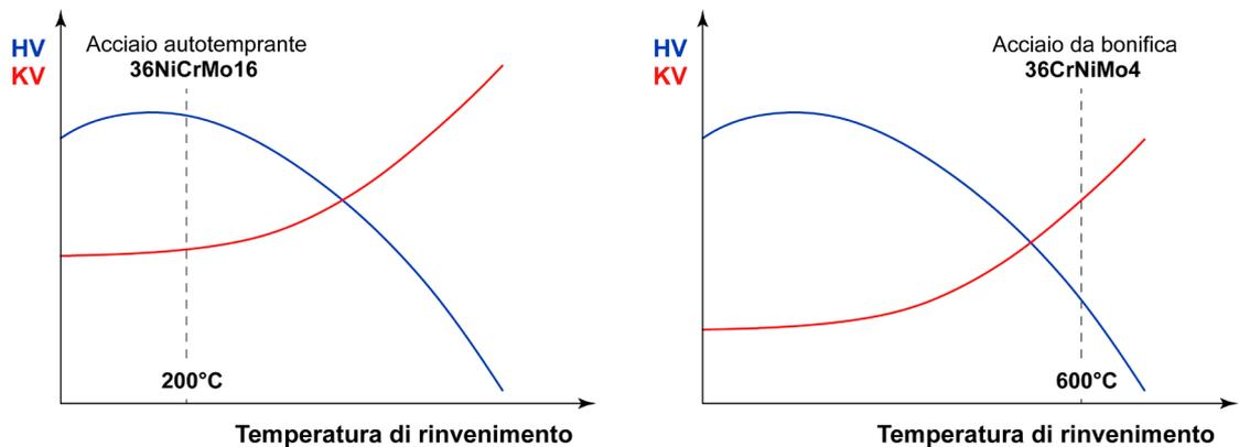
**Figura 15.3** – Andamento schematico della durezza (HV), del carico unitario di rottura ( $R_m$ ) e della resilienza (KV) in funzione della temperatura di rinvenimento per l'acciaio autotemprante EN 36NiCrMo16 e per l'acciaio da bonifica EN 36CrNiMo4.
