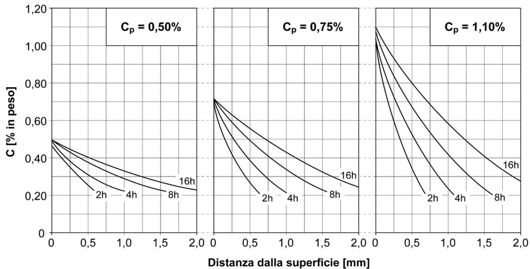
**Figura 17.3** – Effetto del tempo di trattamento e del potenziale di carbonio su processi di cementazione a 920°C per un acciaio tipo EN C20 [tratto da Thelning 1975].
