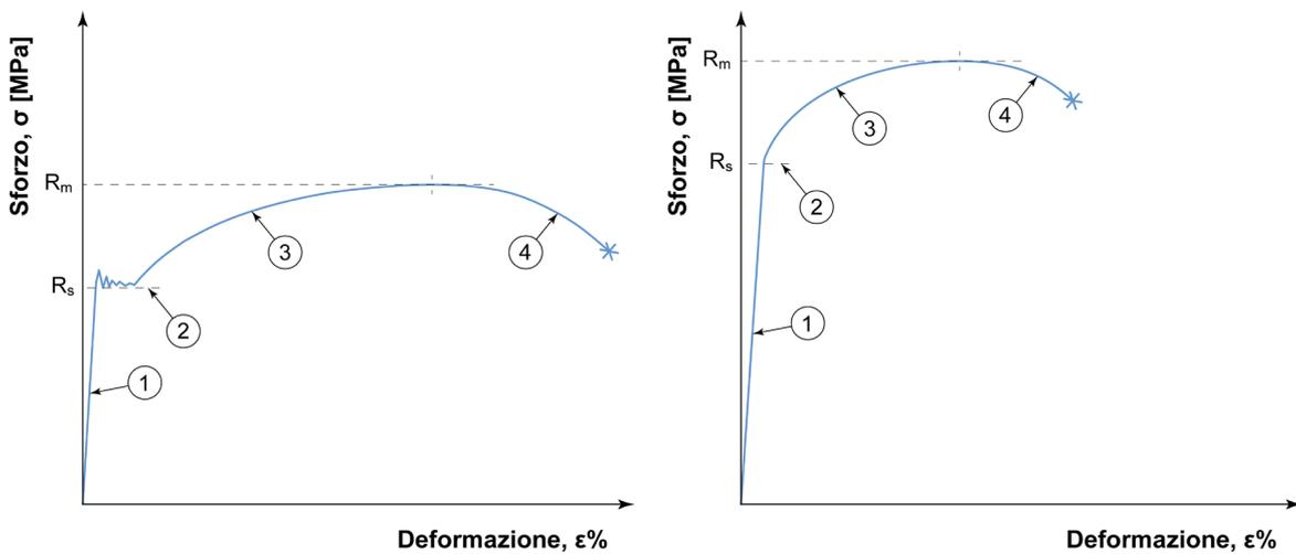
**Figura 2.6** – Indicazione delle quattro zone in cui può essere suddivisa la curva  $\sigma$ - $\epsilon$  di un acciaio da costruzione di uso generale tipo EN S275 e di un acciaio da bonifica tipo EN C40 allo stato temprato e rinvenuto a 620°C.
