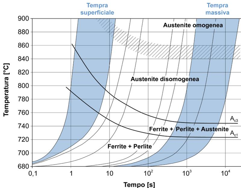
**Figura 14.1** – Andamento delle temperature dei punti critici  $A_{c3}$  e  $A_{c1}$  per un acciaio con  $C = 0,7\%$  per effetto di differenti velocità di riscaldamento. Il concetto di omogeneo/disomogeneo si riferisce alla distribuzione del carbonio nel reticolo della fase  $\gamma$  [tratto da Thelning 1975].
