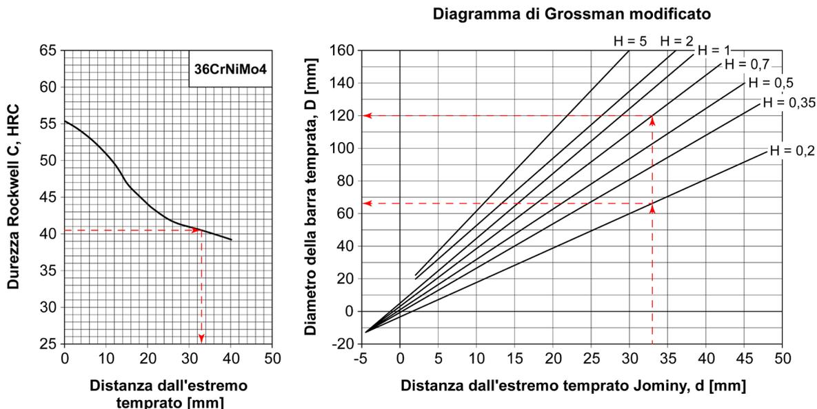
**Figura 13.6** – Curva Jominy per l'acciaio EN 36CrNiMo4 e diagramma di Grossmann modificato. Esempio di calcolo del diametro di barre col 50% di martensite a cuore temprate usando fluidi con drasticità  $H=0,2$  e  $H=0,7$ .
