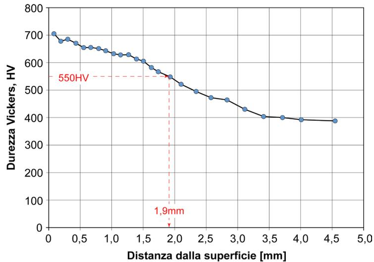
**Figura 17.18** – Profilo di microdurezza, misurato lungo la circonferenza primitiva, per il dente mostrato in figura 17.17. Le linee tratteggiate rosse indicano la modalità di determinazione della profondità efficace [Laboratori del Dipartimento di Meccanica del Politecnico di Milano – MI].
