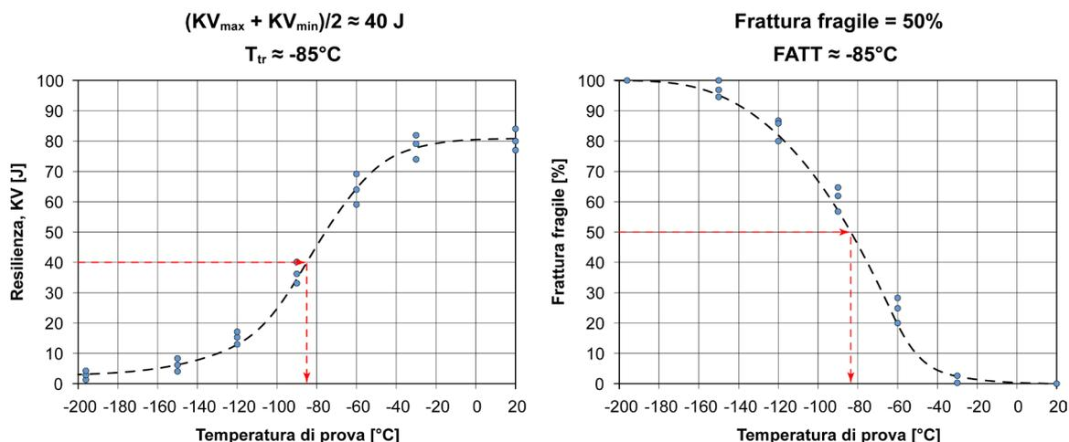
**Figura 4.7** – Individuazione della temperatura di transizione a partire dalle curve sperimentali riportate in figura 4.6.
