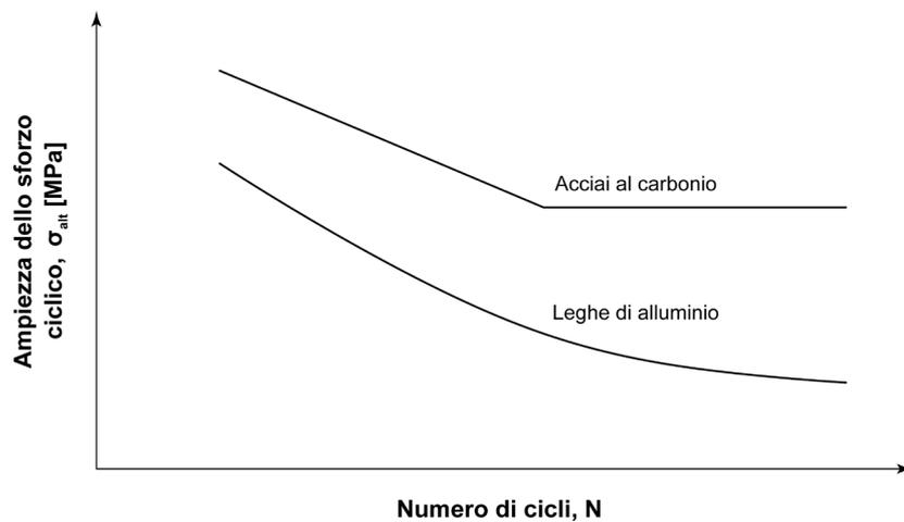
**Figura 6.8** – Curve di Wöhler per un generico acciaio al carbonio (o un generico materiale metallico a reticolo cubico a corpo centrato) e per una generica lega d'alluminio (o un generico materiale metallico a reticolo cubico a facce centrate).
