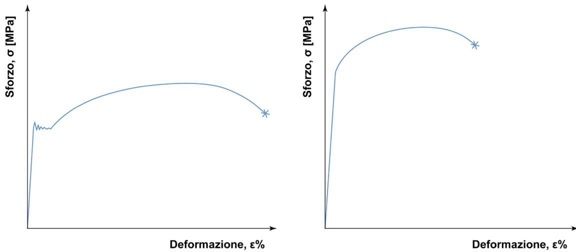
**Figura 2.5** – Schematizzazione delle curve sforzo-deformazione ( $\sigma$ - $\epsilon$ ) di un acciaio da costruzione di uso generale tipo EN S275 e di un acciaio da bonifica tipo EN C40 allo stato temprato e rinvenuto a 620°C.
