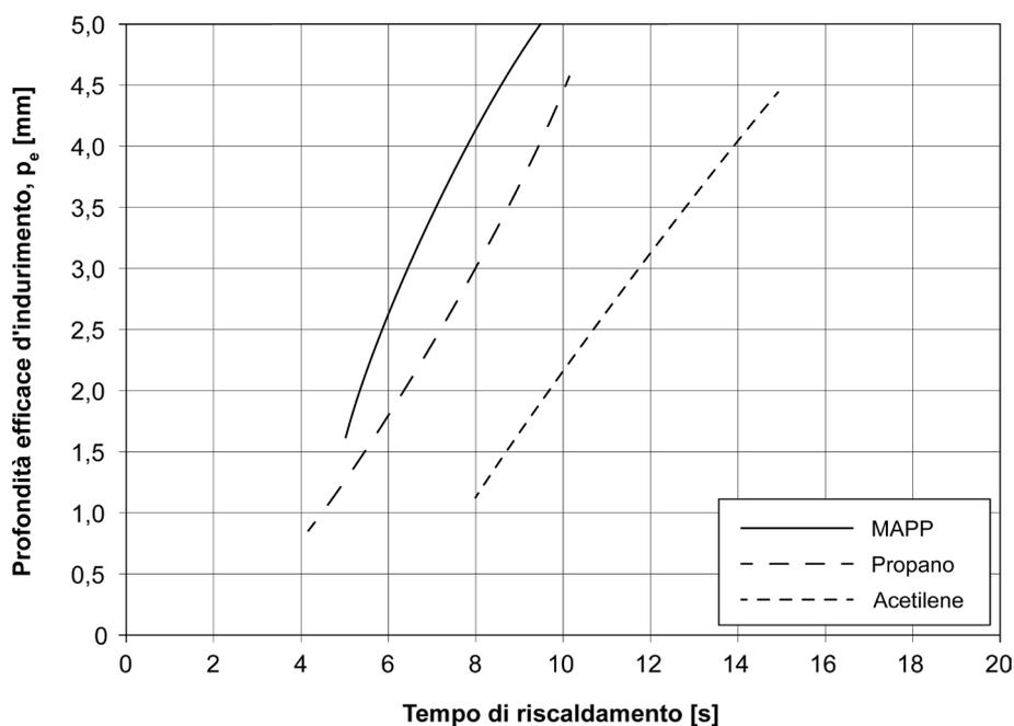
**Figura 14.14** – Confronto tra il tempo di riscaldamento e la profondità efficace di indurimento,  $p_e$ , per differenti combustibili. Velocità di fiamma: 170m/s; distanza del pezzo dal bruciatore: 9,5mm; acciaio EN C35;  $O_2/MAPP = 5$ ;  $O_2/propano = 4,5$ ;  $O_2/acetilene = 5$  [tratto da ASM-H.4A 2013].
