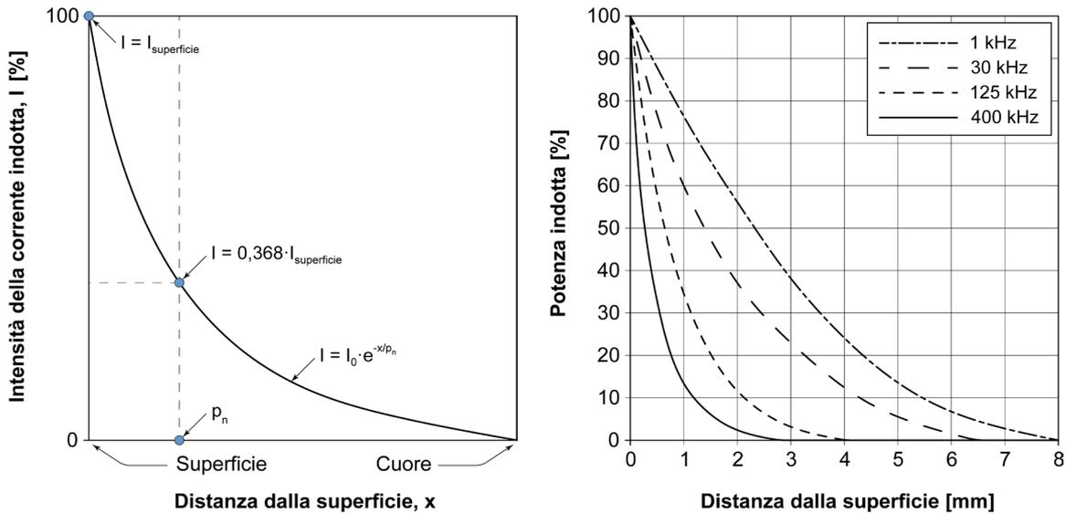
**Figura 14.13** – (a sinistra) Distribuzione della corrente indotta sulla superficie del pezzo a causa dell'effetto pelle [tratto da Davies e Simpson 1979]; (a destra) distribuzione della potenza indotta nel pezzo in funzione della frequenza della corrente [tratto da ASM-H.4 1991].
