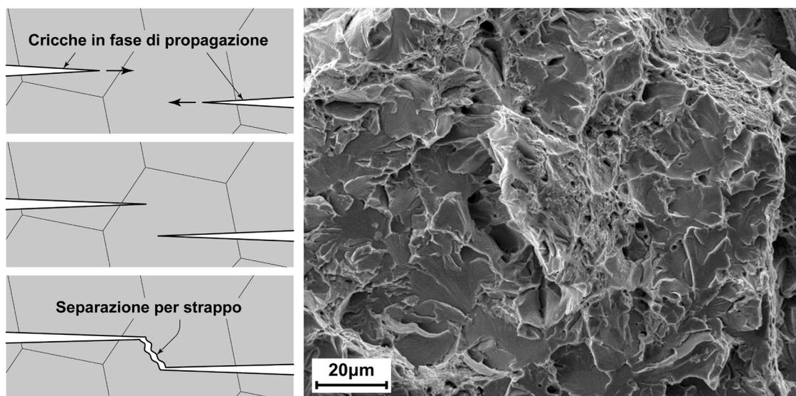
**Figura 5.14** – Illustrazione schematica della separazione per strappo dei legamenti residui tra piani di clivaggio transgranulare ed aspetto al microscopio elettronico a scansione di una superficie di frattura per quasi-clivaggio [Laboratori del Dipartimento di Meccanica del Politecnico di Milano – MI].
