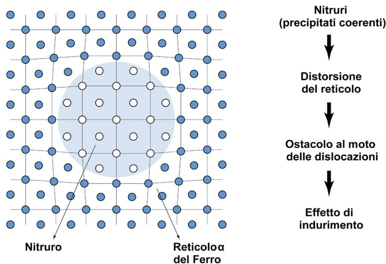
**Figura 18.3** – Rappresentazione schematica del meccanismo di indurimento del reticolo del ferro per effetto della precipitazione di nitruri coerenti [tratto da Díaz 2007].
