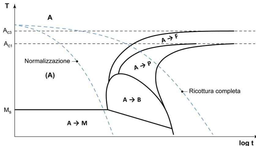
**Figura 15.1** – Curve C.C.T. per un generico acciaio autotemprante: dopo ricottura completa la struttura è costituita da ferrite e perlite, dopo normalizzazione da martensite.
