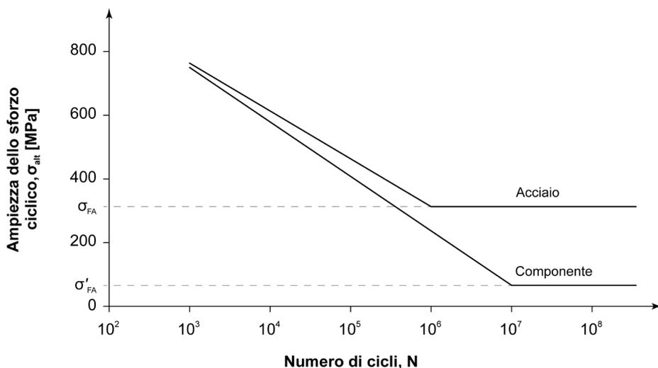
**Figura 6.20** – Curve di Wöhler per un generico acciaio al solo carbonio o debolmente legato e per un componente realizzato usando lo stesso acciaio.  $\sigma_{FA}$  è il limite di fatica dell'acciaio e  $\sigma'_{FA}$  è il limite di fatica del componente realizzato usando quel dato acciaio.
