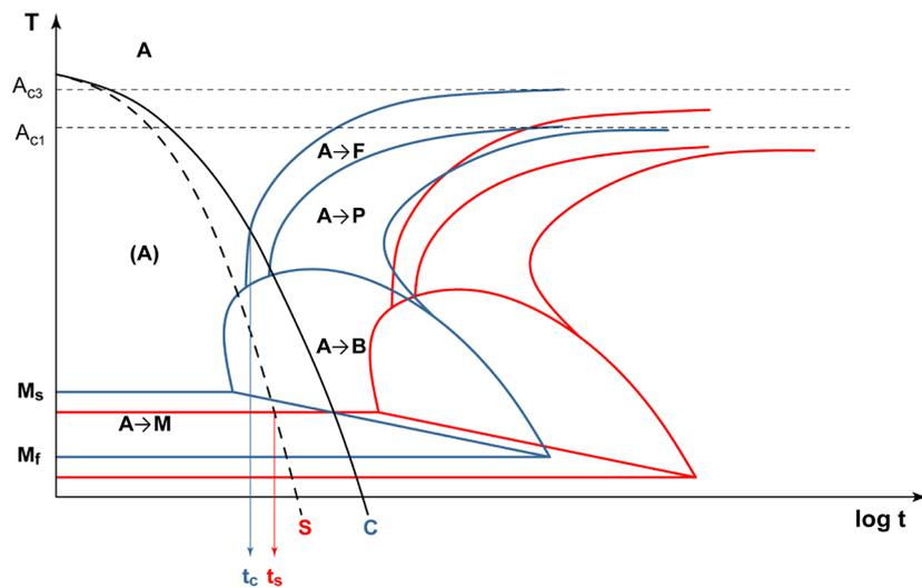
**Figura 17.15** – Andamento schematico delle curve di trasformazione anisoterma dell'austenite per un generico acciaio da cementazione carburato. Le curve C.C.T. dell'acciaio a cuore sono indicate in linea continua blu, le curve C.C.T. dell'acciaio in superficie in linea continua rossa; la curva continua nera rappresenta la traiettoria di raffreddamento dell'acciaio a cuore (C), la curva tratteggiata nera quella dell'acciaio nello strato superficiale indurito (S).
