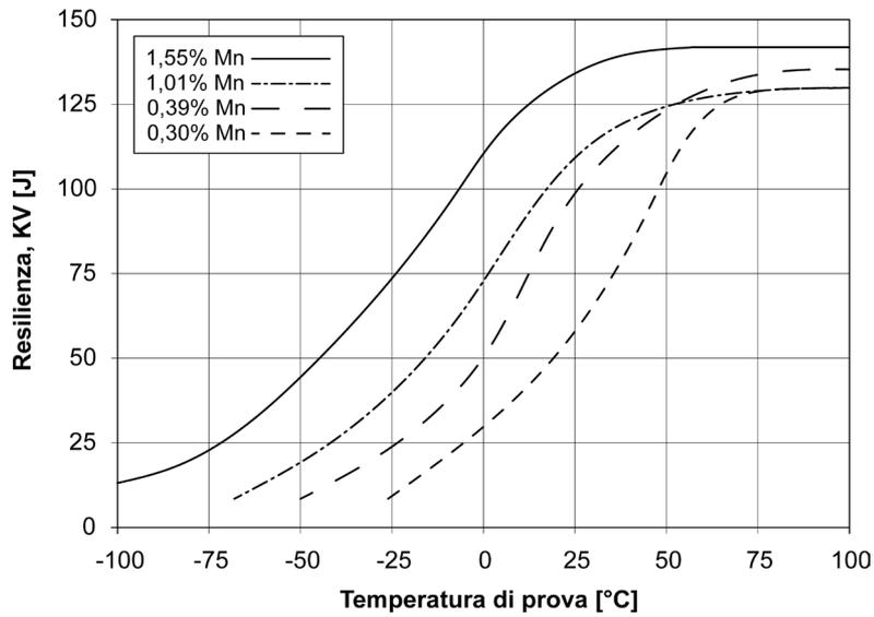
**Figura 4.9** – Effetto del manganese sull’andamento della curva di transizione di un acciaio a medio-basso tenore di carbonio ( $C = 0,30\%$ ; trattamento di normalizzazione; struttura ferritico-perlitica) [tratto da Rineholt e Harris 1951].
