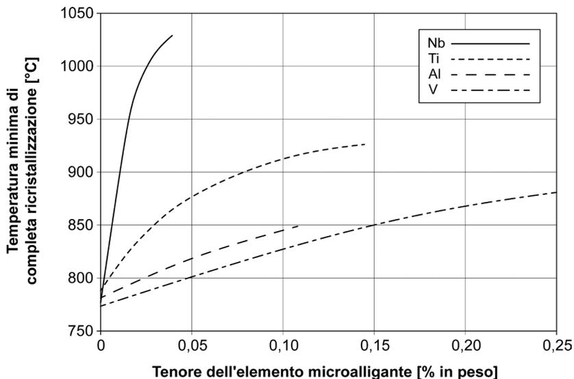
**Figura 10.6** – Andamento della temperatura minima di completa ricristallizzazione in relazione al tenore degli elementi microalliganti aggiunti ad un acciaio con C = 0,07%; Mn = 1,4% e Si = 0,25%; deformazione plastica pari al 10-15% [tratto da Tither 1990].
