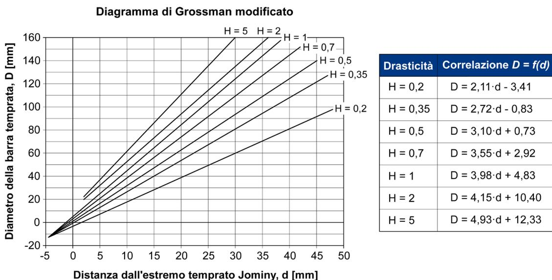
**Figura 13.4** – Diagramma di Grossmann modificato per la determinazione della durezza a cuore di una generica barra di acciaio, in funzione del diametro della barra temprata ( $D$ ), della distanza dall'estremo temprato Jominy ( $d$ ) e della drasticità del mezzo temprante ( $H$ ) [tratto da ASM-H.4 1991].
