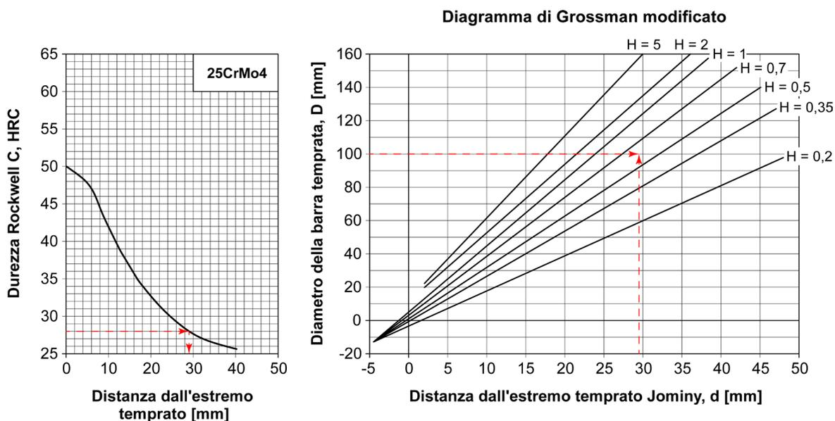
**Figura 13.7** – Curva Jominy per l'acciaio EN 25CrMo4 e diagramma di Grossmann modificato. Esempio di scelta della modalità di spegnimento (parametro  $H$ ) di una barra da 100mm di diametro con durezza a cuore di 28HRC (pari a quella rilevata a 29,5mm dall'estremo temprato).
