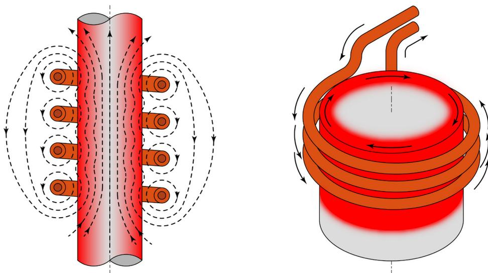
**Figura 14.7** – (a sinistra) Andamento del campo magnetico indotto in una barra cilindrica in acciaio inserita in un induttore solenoide attraverso cui fluisce una corrente elettrica alternata; (a destra) andamento della corrente elettrica nell'induttore e nella barra cilindrica [tratto da Thelning 1975].
