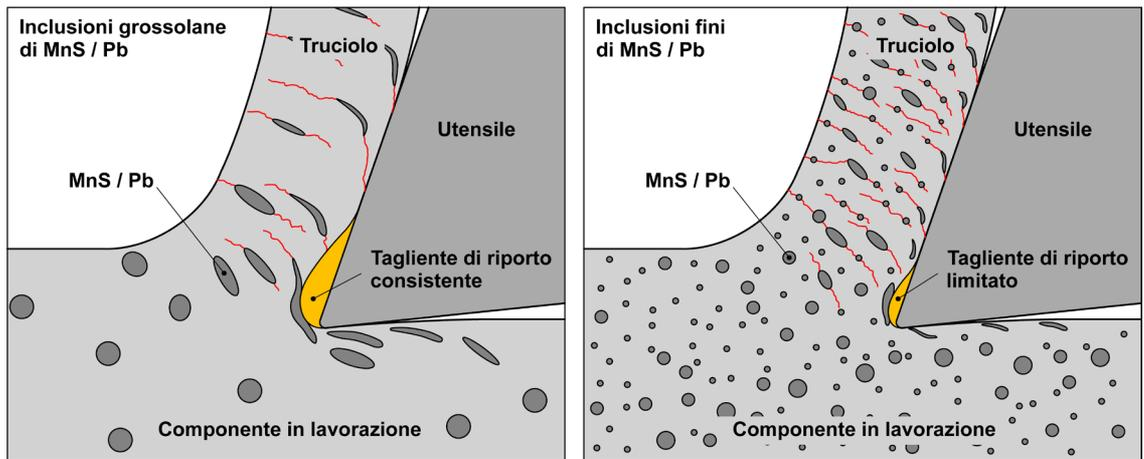
**Figura 9.5** – Effetto della dimensione/distribuzione delle inclusioni nella formazione del truciolo e del tagliente di riporto: (a sinistra) inclusioni grossolane, (a destra) inclusioni di piccole dimensioni. Le linee rosse indicano i possibili piani di frattura del truciolo durante la lavorazione per asportazione mentre l'area arancione evidenzia il tagliente di riporto sull'utensile [tratto da Hashimura et al. 2007].
