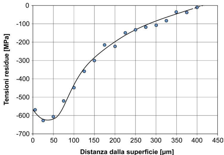
**Figura 18.11** – Andamento delle tensioni residue in uno strato nitrurato su acciaio EN 42CrMo4 (520°C per 50 ore), misurate mediante diffrazione a raggi X [Laboratori del Dipartimento di Meccanica del Politecnico di Milano – MI].
