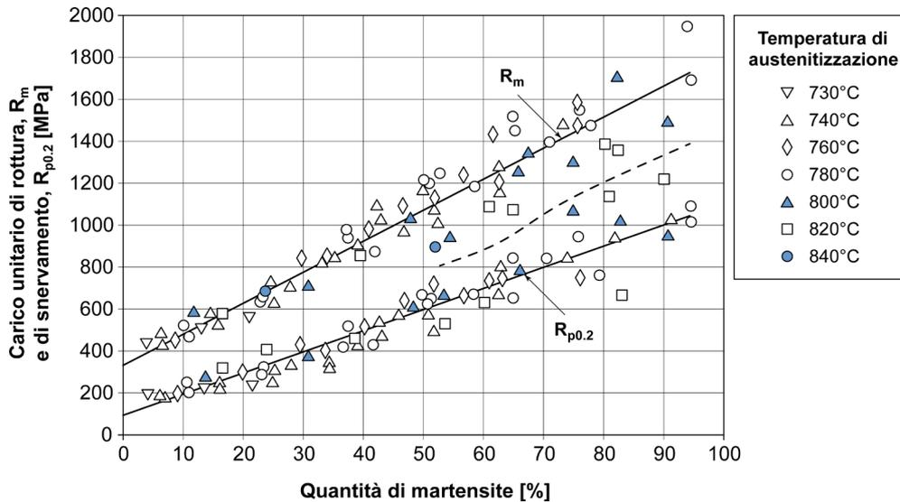
**Figura 11.2** – Influenza della percentuale di martensite sul carico unitario di snervamento,  $R_{p0.2}$ , e di rottura,  $R_m$ , di acciai *Dual Phase* [tratto da Davis 1978].
