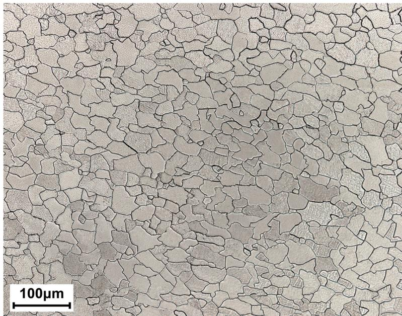
**Figura 9.11** – Aspetto metallografico di un acciaio per formatura a freddo, tipo EN DD14. Si noti la struttura ferritica completamente ricristallizzata; attacco: Nital 2%. [Laboratori del Dipartimento di Meccanica del Politecnico di Milano – MI].
