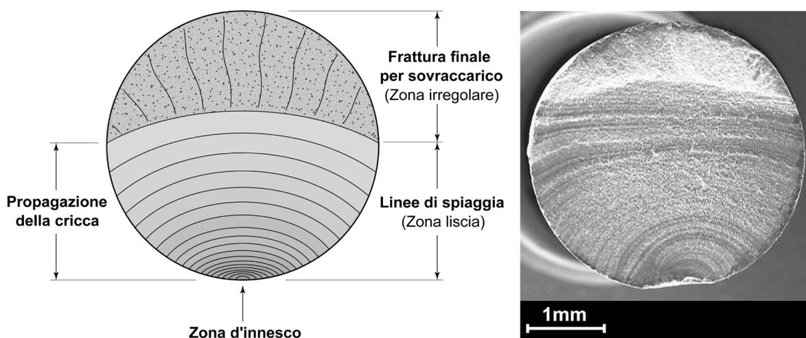
**Figura 6.5** – Rappresentazione schematica dei tre stadi di sviluppo di un cedimento per fatica ed esempio di una tipica superficie di frattura (filo in alluminio di un conduttore dell'alta tensione) [Laboratori del Dipartimento di Meccanica del Politecnico di Milano – MI].
