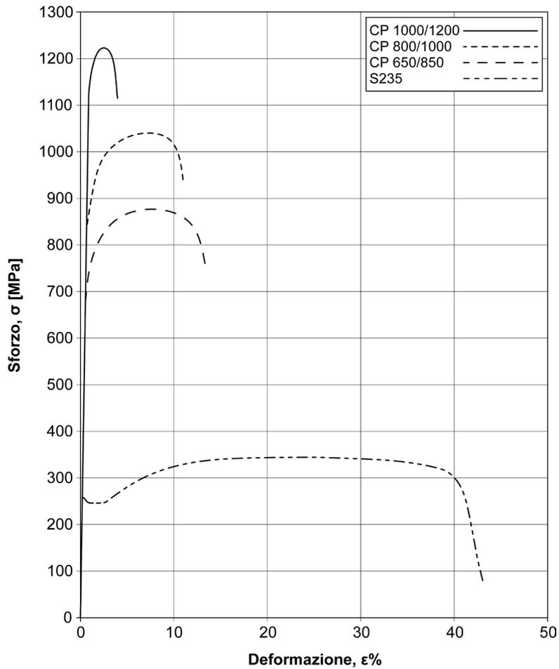
**Figura 11.6** – Curve sforzo-deformazione per alcuni acciai CP (qui identificati con la sigla CP seguita dai valori minimi di  $R_s$  ed  $R_m$ ) a confronto con un generico acciaio EN S235 [tratto da Keeler et al. 2017].
