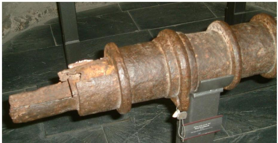
Figura 6: Vista d'insieme del *reperito corto* e particolare dell'estremità con rottura a becco di flauto
