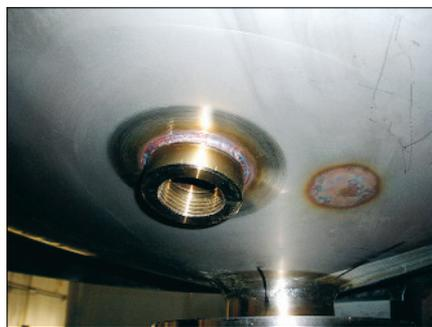
**Fig. 7** Effetto dell'impiego di paste decapanti su cordoni di saldatura: una scatola metallica (in alto) e un serbatoio di stoccaggio (in basso). [per cortesia della società Azzini S.p.A., Soresina (CR)].
