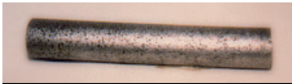
FIG 09 Corrosione intergranulare su un tubo trattato termicamente in modo errato.
