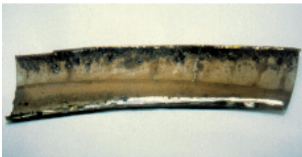
FIG 13 Risultato del fenomeno dell'ossidazione a caldo.
