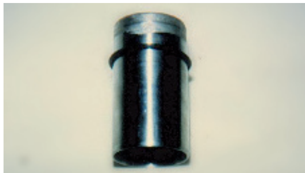
FIG|07| Crevice corrosion sotto la sede di una guarnizione.
