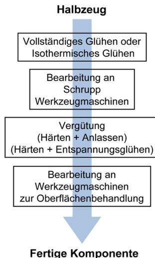
**Abbildung 18** - Technologisches Verfahren zur Herstellung eines Bestandteils aus martensitischem nichtrostendem Stahl.
