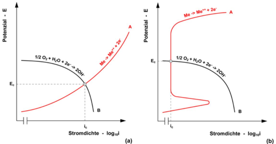
**Abbildung 48** – Potenziodynamische Kurven (anodisches Merkmal A: Material –kathodisches Merkmal B: Umgebung) in wässriger Lösung 0,05 M  $H_2SO_4$ : (a) für ein Material mit aktivem Verhalten und (b) für ein Material mit aktiv-passivem Verhalten.
