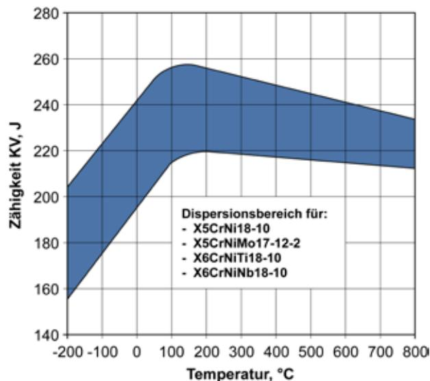
**Abbildung 40** - Verlauf der Kerbschlagfähigkeit verschiedener austenitischer nicht rostender Stähle nach Charpy V bei verschiedenen Temperaturen [aus Llewellyn und Hudd 2003].
