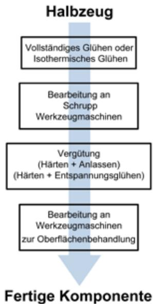
**Abbildung 18** - Technologisches Verfahren zur Herstellung eines Bestandteils aus martensitischem nicht rostendem Stahl.
