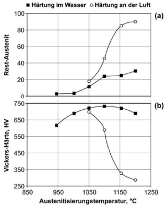
**Abbildung 21** - Auswirkungen der Austenitisierungstemperatur und des Härteverfahrens auf die Härte und den % des Restaustenits in einem martensitischen nicht rostenden Stahl mit 0,4% C - 16% Cr - 0,9% Mo - 0,5% Ni [aus Lacombe et al. 1993].
