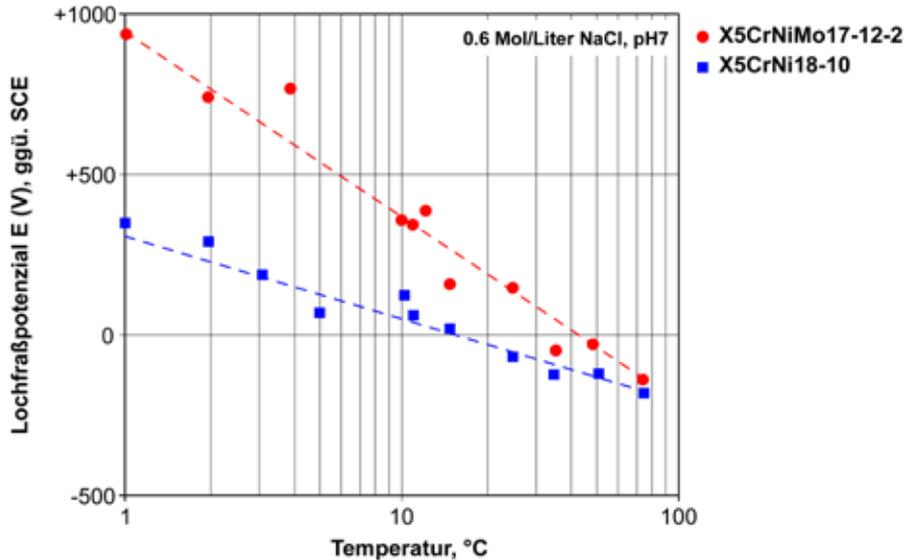
**Abbildung 64** – Verlauf des Pitting-Potenzials in Abhängigkeit von der Lösungstemperatur für nichtrostende austenitische Stähle X5CrNi18-10 und X5CrNi17-12-2; wässrige Lösung 0,6M NaCl a pH 7 [Shirer 1994].
