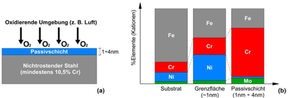
**Abbildung 1** – (a) Mechanismus der Passivierung unlöslicher Stähle nach Kontakt mit der Atmosphäre und b) schematische Darstellung der Elemente, die in der passiven Schicht, in der Schnittstelle und im Substrat eines nicht rostenden Stahls 18%Cr-14,3%Ni-2,5%Mo [aus Olefjord und Elfstrom 1982] enthalten sind.
