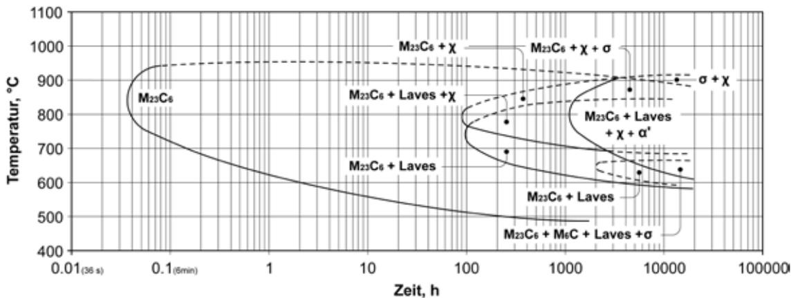
**Abbildung 37** - Zeit-Temperatur-Diagramm, das die Ausscheidung der Phasen  $\sigma$ ,  $\chi$ , Laves und der Chromkarbide in einem austenitischen nicht rostenden Stahl des Typs X5CrNiMo17-12-2 zeigt [aus Khatak und Baldev 2002].
