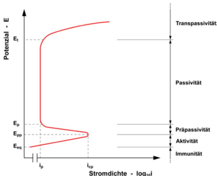
**Abbildung 49** – Schematisierung des anodischen Merkmals eines gemeinen nichtrostenden Stahls.
