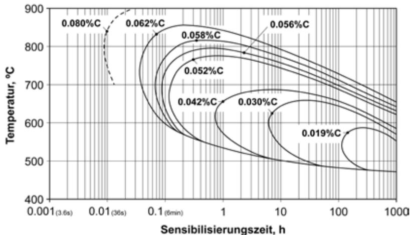
**Abbildung 36** - Zeit-Temperaturdiagramm („C-Kurve“), das die Ausscheidung der Chromkarbide bei verändertem Kohlenstoffanteil eines austenitischen nicht rostenden Stahls mit 18% Chrom und 9% Nickel [aus McGuire 2008] zeigt.
