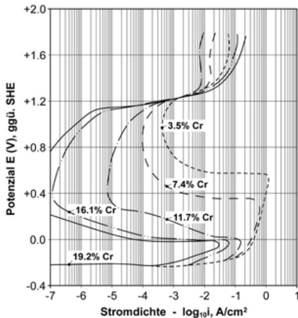
**Abbildung 52** – Wirkung von Chrom auf die anodischen Eigenschaften (potenziodynamische Kurven) von Eisen-Chromlegierungen mit 8,3-9,6% Nickelanteil; wässrige Lösung 1M  $H_2SO_4$  bei 90°C [Osozawa und Engell 1966].
