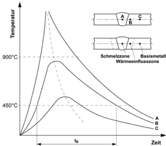
**Abbildung 74** – Zeitabhängiger Temperaturverlauf einer Schweißverbindung. Die intergranulare Korrosion kann im Bereich B auftreten, der dem kritischen Intervall stärker ausgesetzt ist als A und C.
