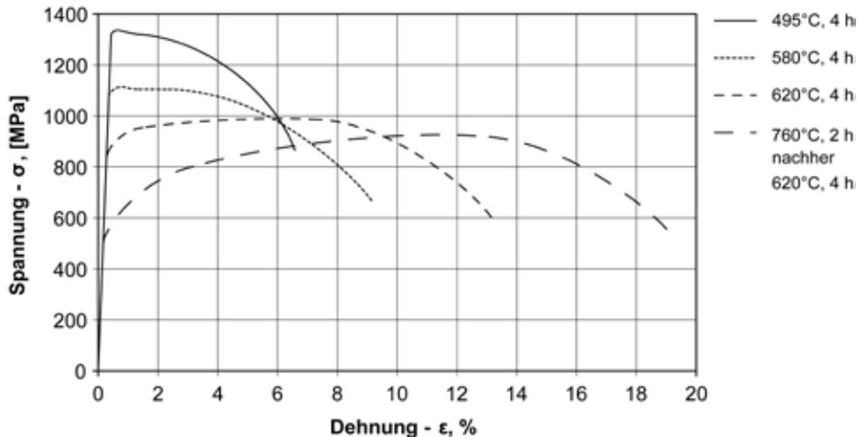
**Abbildung 43** - Stahl X5CrNiCuNb16 (auch 17-4 PH genannt), bei -1050°C an der Luft lösungsgeglüht und dann unterschiedlich gealtert: Kurve  $\sigma$  -  $\epsilon$  [Labore der Abteilung Mechanik, Politecnico Milano, Mailand].
