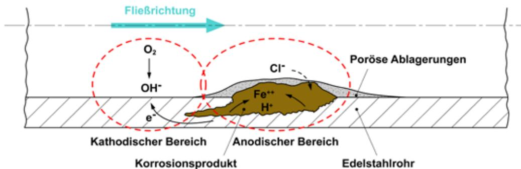
**Abbildung 73** – Schematisierung einer Korrosionserscheinung durch Ablagerung in einer Rohrleitung.
