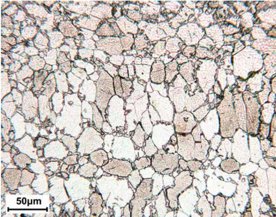
Kaltgewalztes und getempertes Blech; nach Widerstandsschweißen thermisch veränderter Bereich
