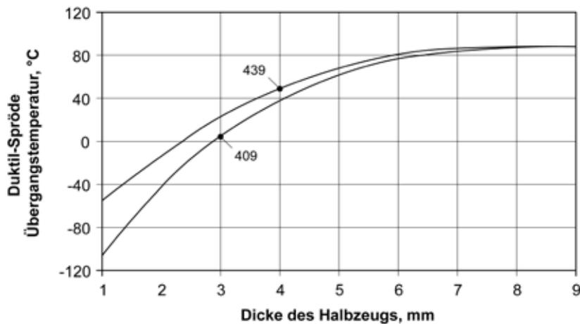
**Abbildung 33** - Folgen der Dicke des Halbfertigprodukts auf die Übergangstemperatur zweier ferritischer nicht rostender Stähle [aus Sedriks 1996].
