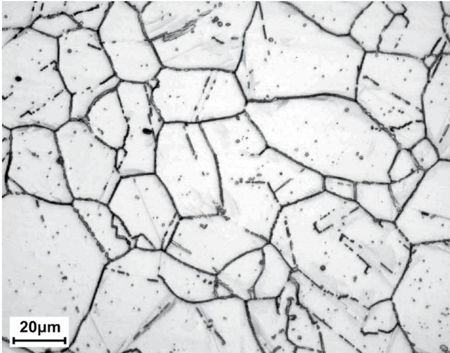
Warmgewalztes, lösungsgeglühtes und sensibilisiertes Blech
