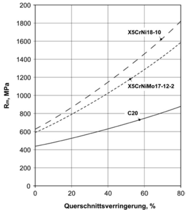
**Abbildung 39** - Folgen der Verringerung des Querschnitts durch Kaltwalzen auf die Verbesserung der einheitlichen Dehnfestigkeit  $R_{p0,2}$  und auf die Umwandlung von Austenit im Martensit verschiedener nicht rostender Stähle [aus Llewellyn und Hudd 2003].
