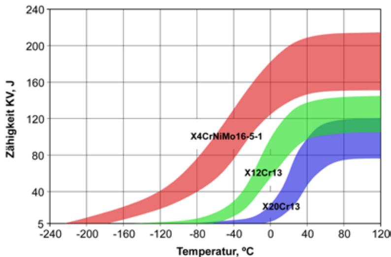
**Abbildung 23** - Übergangskurven einiger martensitischer nicht rostender Stähle nach Härten und Anlassen bei 650°C.
