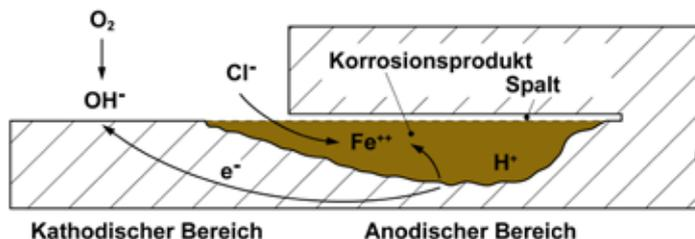
**Abbildung 71** – Schematisierung der Spaltkorrosion oder Crevice.
