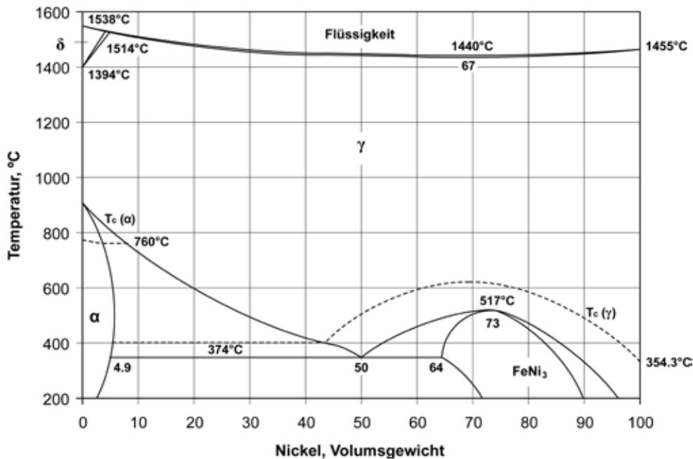
**Abbildung 7** - Das Fe-Ni-Zustandsdiagramm [aus ASM-H.3 1992].
