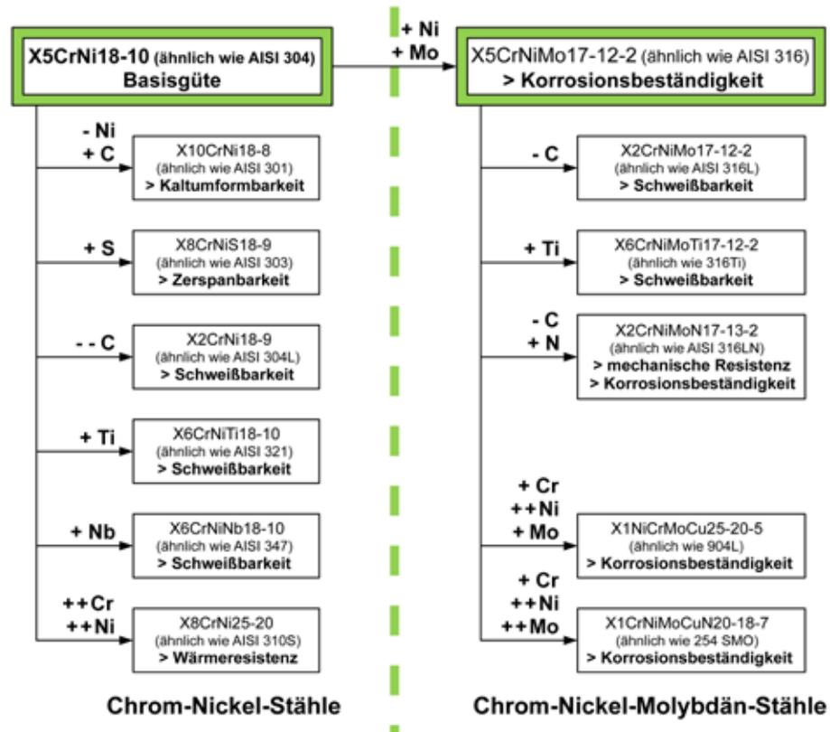
**Abbildung 34** - Schema der Haupttypen austenitischer nicht rostender Stähle mit Chrom-Nickel und mit Chrom-Nickel-Molybdän ausgehend von X5CrNi18-10 und X5CrNiMo17-12-2.
