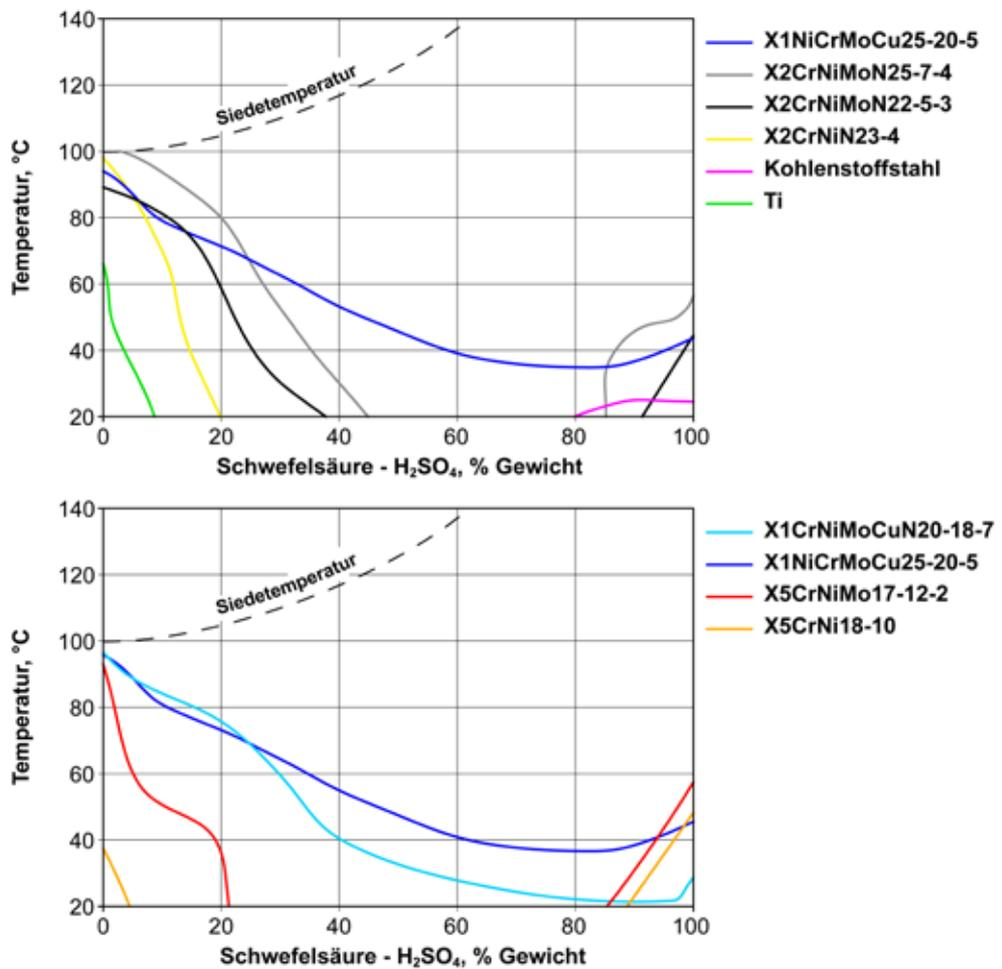
**Abbildung 58** – Isokorrosionskurven (0,1 mm/Jahr) für einige nichtrostende Stähle in Schwefelsäure; die gestrichelte Kurve gibt den Siedepunkt an [aus Outokumpu 2009].
