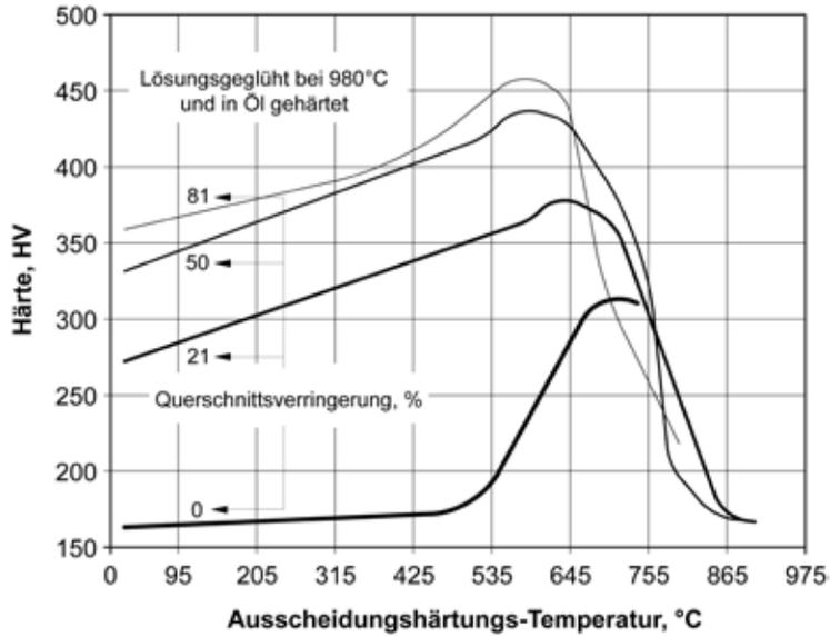
**Abbildung 45** - Verlauf der Härte je nach Alterungstemperatur eines Stahls X5NiCrTiMoVB25-15-2 (auch A-286 genannt) nach Lösungsglühen, Ölhärten, Kaltwalzen bei verschiedenen Niveaus der Kaltumformung.
