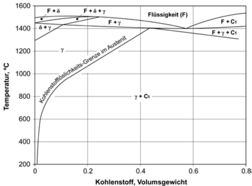
**Abbildung 35** - Fe-C-Zweistoffgemisch des Fe-Cr-Ni-C-Viereckdiagramms mit Cr = 18% und Ni = 8%; typische  $C_1$ -Karbide  $(Cr,Fe)_{23}C_6$  [aus Sedriks 1996].
