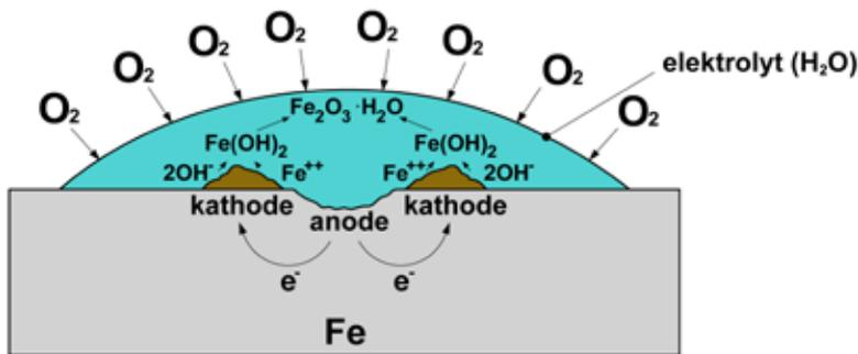
**Abbildung 47** – Modell von Evans; elektrochemische Korrosion eines homogenen metallischen Werkstoffs [Pedefferri 2010].
