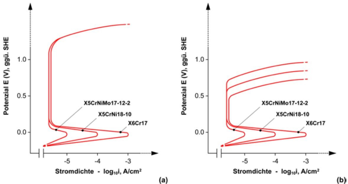
**Abbildung 54** – Potenziodynamische Kurven für drei nichtrostende Stähle in sauren Lösungen mit Chloridzusatz: (a) Schwefelsäurelösung 0,05M, (b) Schwefelsäurelösung 0,05M und 0,1M Natriumchlorid. [Talbot und Talbot 1998].
