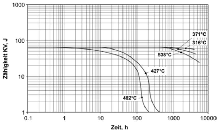
**Abbildung 28** - Verlauf der Widerstandsfähigkeit in ferritischen nicht rostenden Stählen mit 18% Chrom, die bei 316°C, 371°C, 427°C, 482°C und 538°C bei allmählich zunehmenden Zeiten ausgehärtet wurden [aus Grobner 1973].
