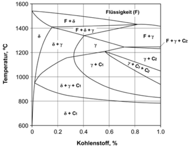
**Abbildung 16** - Fe-C-Zweistoffgemisch des Fe-Cr-C-Dreiecksdiagramms mit Cr = 17%; Typische C<sub>1</sub> Karbide (Cr, Fe)<sub>23</sub>C<sub>6</sub>, typische C<sub>2</sub> Karbide (Cr, Fe)<sub>7</sub>C<sub>3</sub> [aus Lippold und Kotecki 2005].
