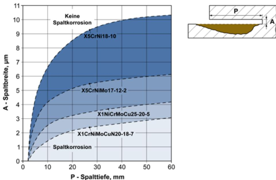
**Abbildung 72** – Geometrische Eigenschaften der Spalte, die in Abhängigkeit vom verwendeten nichtrostenden Stahl zu Crevice führen können [Sedriks 1996].
