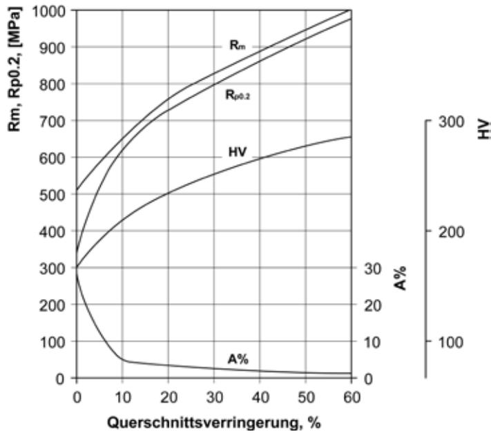
**Abbildung 31** - Folgen der Kaltumformung auf die mechanischen Eigenschaften eines ferritischen nicht rostenden Stahls X6Cr17 Art (ähnlich AISI 430) [aus Lacombe et al. 1993].
