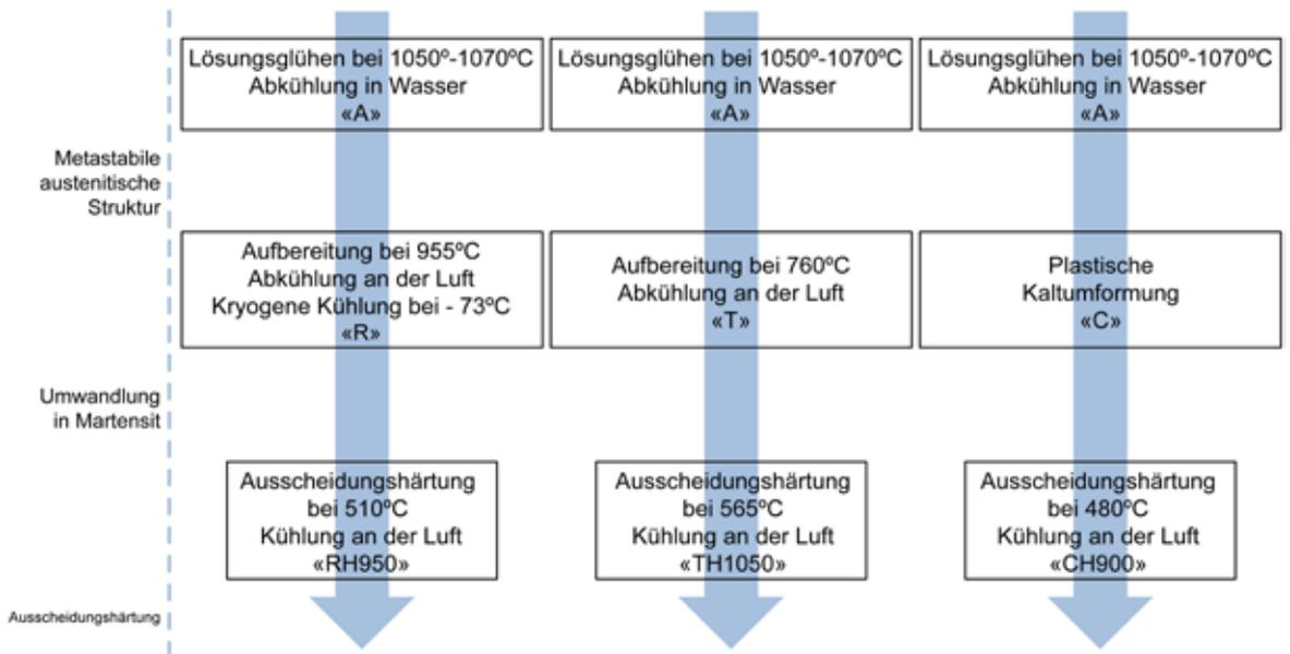
**Abbildung 44** - Stahl X7CrNiAl17-7 (auch 17-7PH genannt): Mögliche thermische und thermomechanische Verfahren zur Ausscheidungshärtung.
