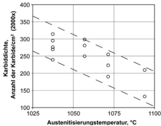
**Abbildung 19** - Auswirkungen der Austenitisierungstemperatur auf die Dichte der Chromkarbide nach dem Härten in einem martensitischen nicht rostenden Stahl mit 0,65% C - 12,8% Cr - 0,4% Si - 0,65% Mn [aus Verhoeven 2007].
