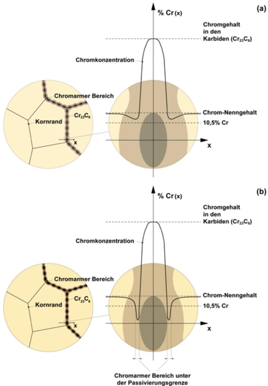
**Abbildung 10** - Verlauf der Chromkonzentration an einer Korngrenze, an der ein Chromkarbidniederschlag stattgefunden hat: a) eines ferritischen nicht rostenden Stahls (hohe Chromverbreitung); b) eines
