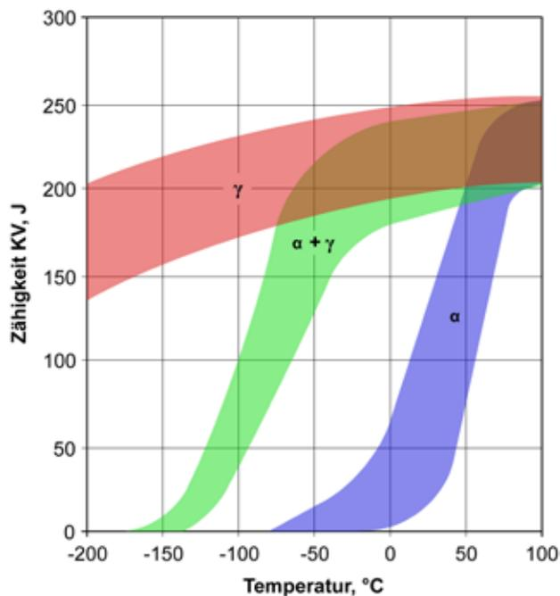
**Abbildung 42** - Auswirkungen des Mikrogefüges auf die Kerbzähigkeit einiger Gruppen nicht rostender Stähle ( $\gamma$  = Austenit,  $\alpha + \gamma$  = Ferrit und Austenit;  $\alpha$  = Ferrit) [aus Nicodemi 2002].
