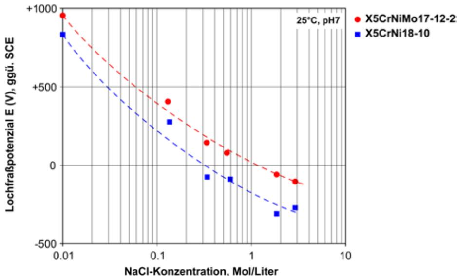
**Abbildung 65** – Verlauf des Pitting-Potenzials in Abhängigkeit von der Konzentration der Chloride in der Lösung für nichtrostende austenitische Stähle X5CrNi18-10 und X5CrNi17-12-2; wässrige Lösung mit pH 7 bei 25°C [Shirer 1994].
