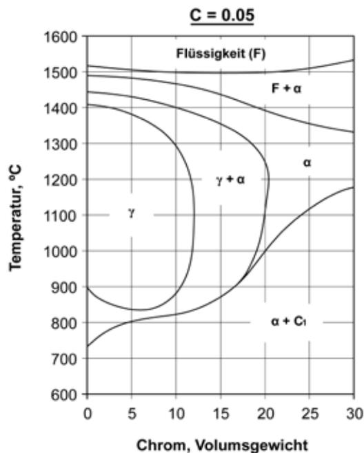
**Abbildung 25** - Fe-Cr-Zweistoffgemisch des Fe-Cr-C-Dreiecksdiagramms für einen Stahl mit 0,05 Kohlenstoff; typisches  $C_1$ -Karbid  $(Cr, Fe)_{23}C_6$  [aus McGuire 2008].
