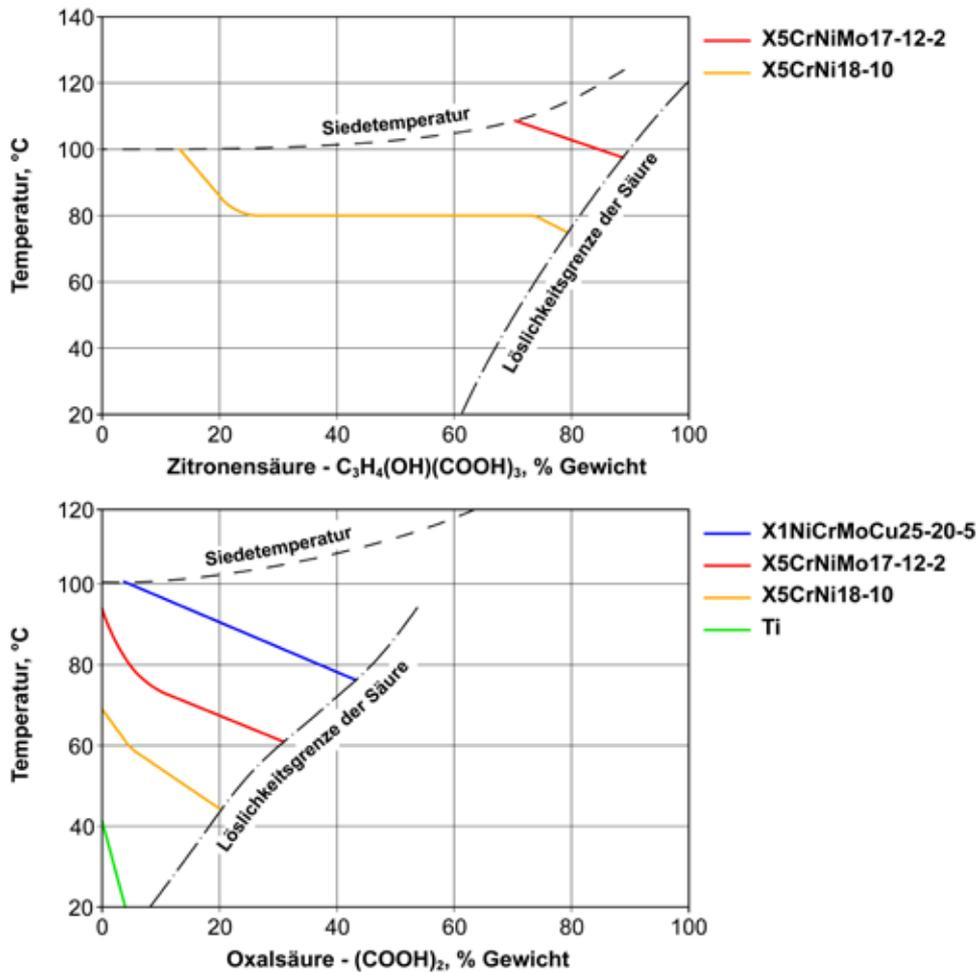
**Abbildung 57** – Isokorrosionskurven (0,1 mm/Jahr) für einige nichtrostende Stähle in (a) Zitronensäure und (b) Oxalsäure; die gestrichelte Kurve gibt den Siedepunkt an [aus Outokumpu 2009].
