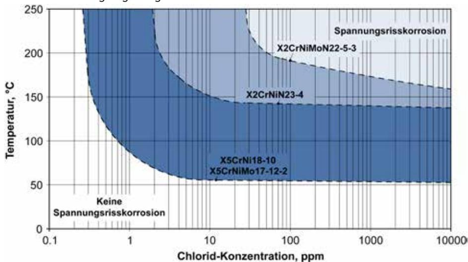
**Abbildung 79** – Auswirkung von Temperatur und Konzentration gelöster Chloride auf die Spannungskorrosionsbeständigkeit einiger nichtrostender austenitischer und austenoferritischer Stähle [Sedriks 1996].
