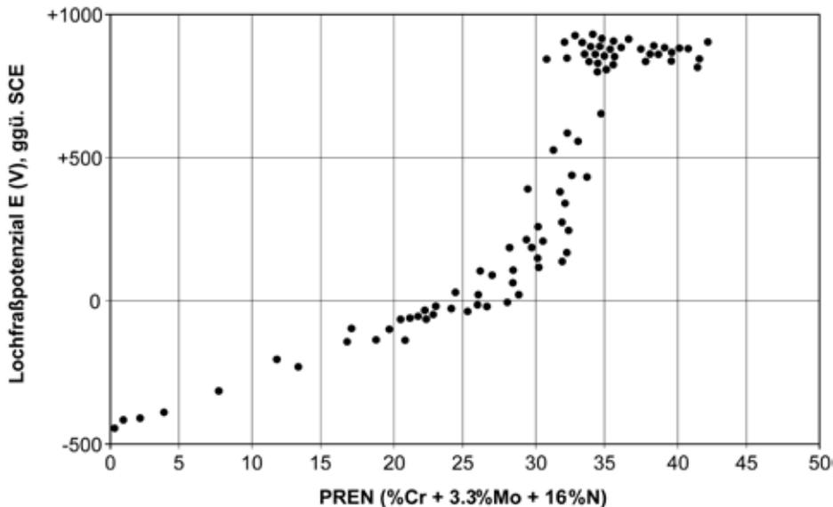
**Abbildung 68** – Verlauf des Pitting-Potenzials in Abhängigkeit vom PREN in wässriger Lösung 0,5M NaCl bei 50°C mit pH-Wert 6,6; Eisenlegierungen mit %Cr=0,021÷28 %Ni=0,22÷20,39 %Mo=0,01÷4,23 %N=0,01÷0,455 %Mn=0,22÷4,53 %Si=0,13÷0,71 [Shirer 1994].
