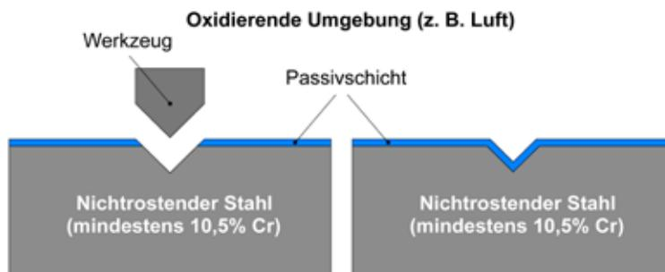
**Abbildung 2** - Mechanischer Abtrag der passiven Schicht und darauffolgende erneute Passivierung der nicht rostenden Stähle [aus Baddoo 1995].
