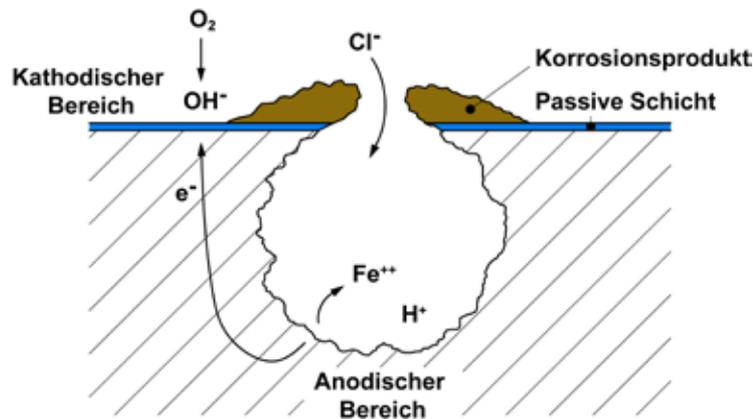
**Abbildung 63** – Schematisierung des Beschädigungsmechanismus bei Pitting.
