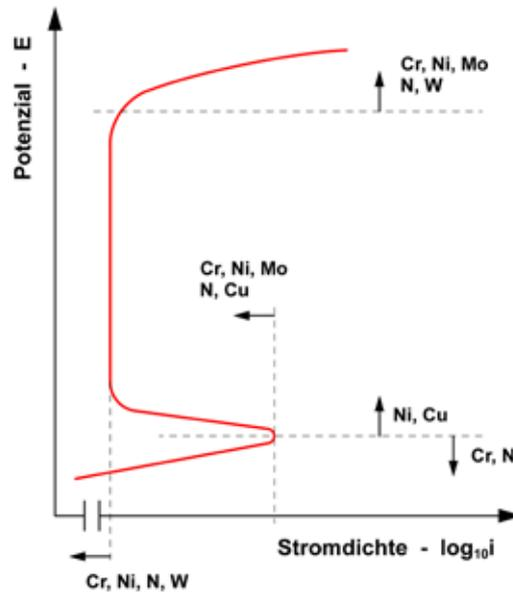
**Abbildung 53** – Schematischer Verlauf der aktiv-passiven Kennlinie nichtrostender Stähle in Abhängigkeit vom Anteil der verschiedenen Bestandteile der Legierung [Sedriks 1986].
