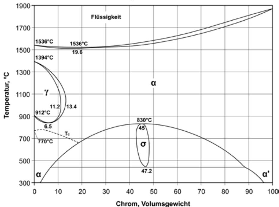
Abbildung 5 - Das Fe-Cr-Zustandsdiagramm [aus ASM-H.3 1992].
