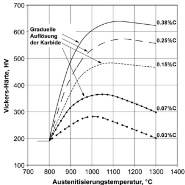
**Abbildung 20** - Auswirkungen der Austenitisierungstemperatur auf die Härte eines martensitischen nicht rostenden Stahls mit 13% Cr und steigendem Kohlenstoffanteil (in Öl gehärtet und dann bei 200°C entspannt) [aus Lacombe et al. 1993].
