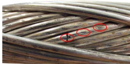
Analisi visiva del conduttore - sono evidenti le macchie di forma ellittica dovute allo sfregamento dei fili (fretting)
