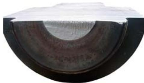
Rotore, superficie di frattura - si notino le linee di spiaggia e la zona di rottura finale
