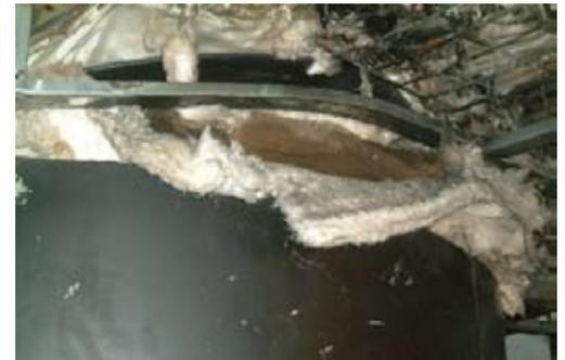
Silenziatore - è evidente l'elevata deformazione plastica dovuta allo scoppio del silenziatore
