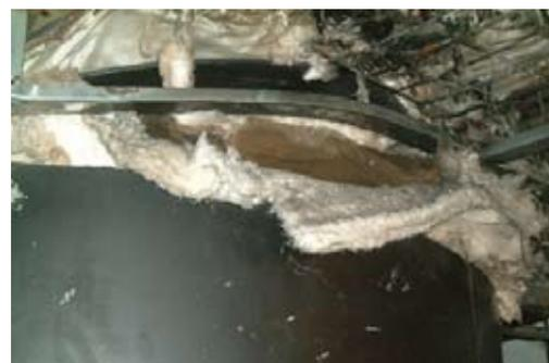
Silenziatore - è evidente l'elevata deformazione plastica dovuta allo scoppio del silenziatore
