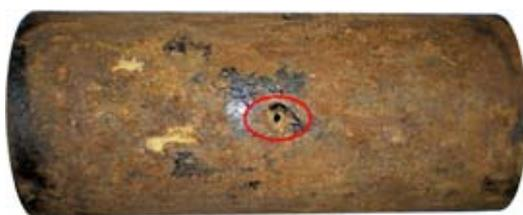
Spezzone di tubo danneggiato. Nella zona centrale è ben evidente il foro passante di forma conica.
