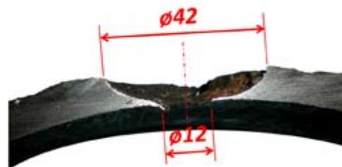
Sezione trasversale del foro (Dmax = 42mm, Dmin = 12mm)
